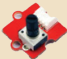
Unghiul rotativ (Rotary Angle) – Un comutator cu un cadran utilizat pentru a controla tensiunea de ieșire.
